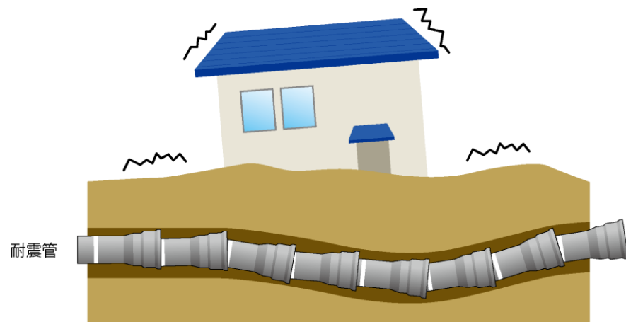
地震時の耐震継手のダクタイル鋳鉄管のイメージ図
