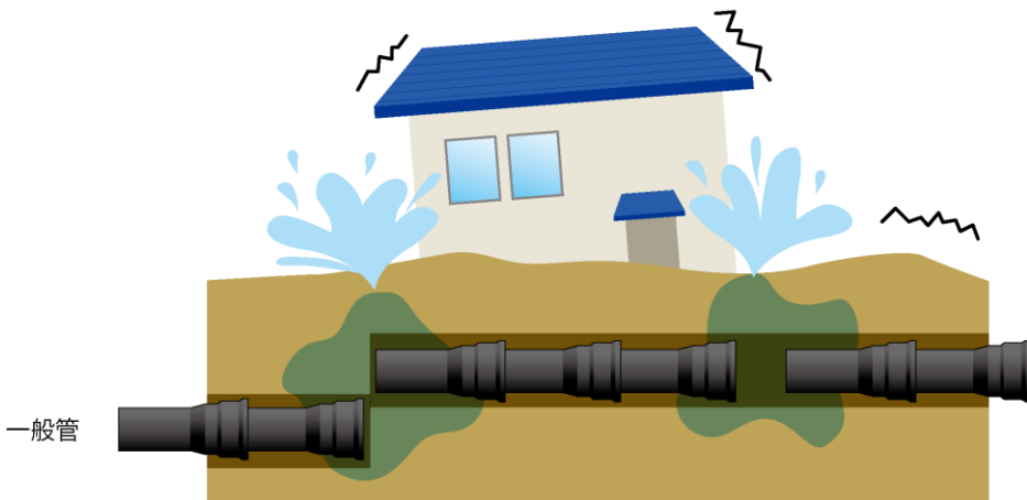
地震時のK形ダクタイル鋳鉄管のイメージ図
