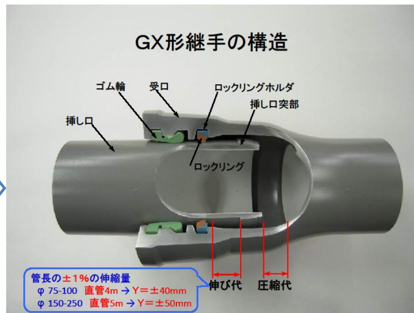
耐震継手(離脱防止機能有り) 16
