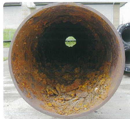
平成17年 破裂 鋳鉄管 直径450mm (昭和29年布設)
