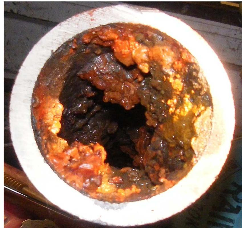
鑄鉄管  $\Phi 75\text{mm}$
