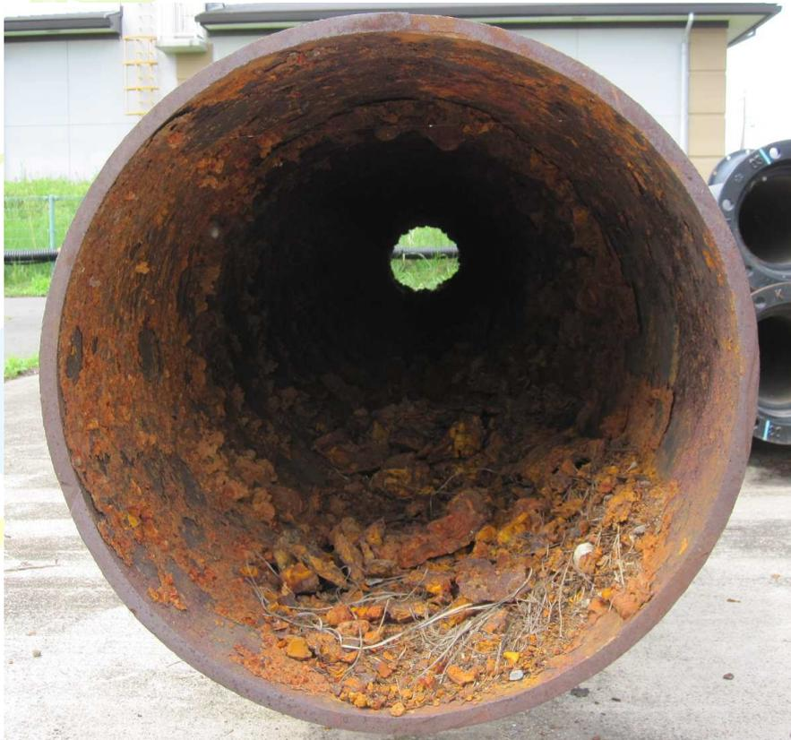
鑄鉄管  $\Phi 450\text{mm}$
