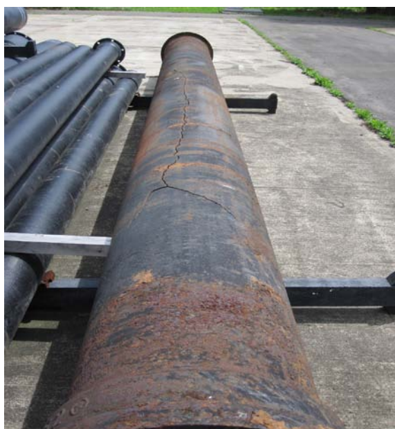
亀裂により漏水が発生した配水幹線（昭和29年供用開始 \phi 450 mm）
