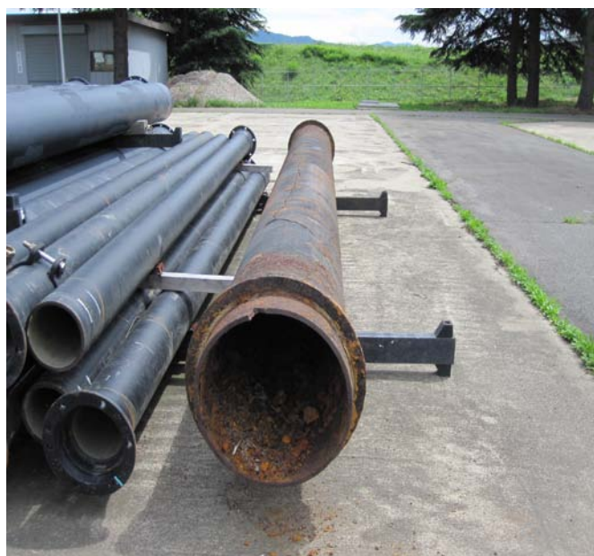
亀裂により漏水が発生した配水幹線（昭和29年供用開始 \phi 450 mm）
