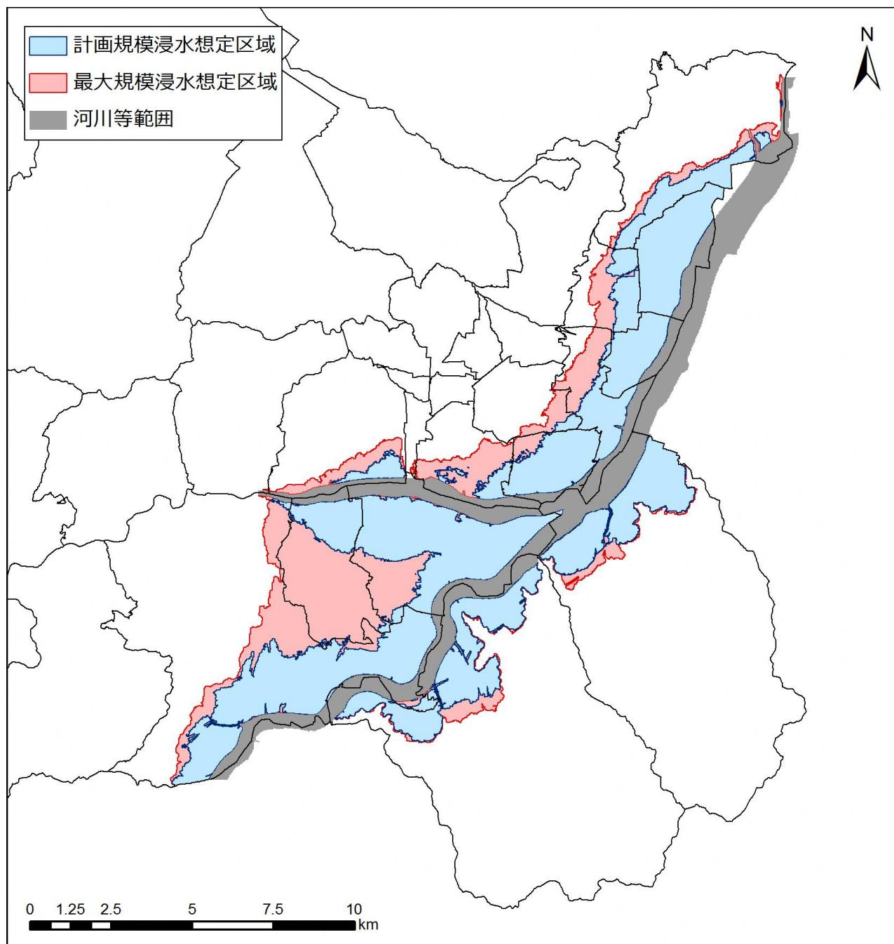
〈計画規模浸水想定区域図と想定最大規模浸水想定区域図の比較図〉
