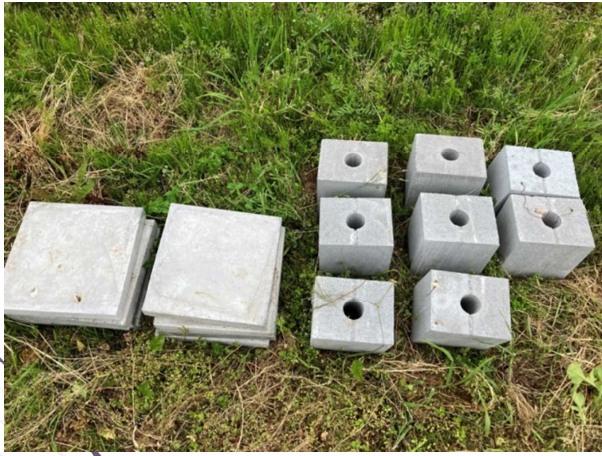
単管ベースピンコロとコンクリート平板
