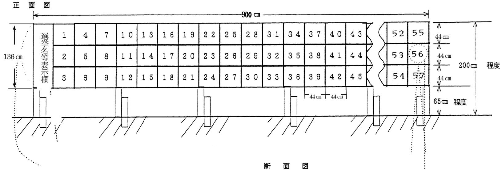
※各設置方式とも、掲示板の下端から地上部までの高さを65cm以上確保するとともに、地上部から掲示板の上端までの高さを200cm程度とすること。
