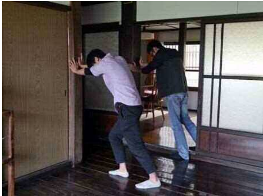
建造物の耐震性能調査(人力加振実験)
